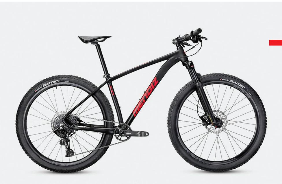
Il s'agit d'un vélo doté d'un cadre rigide en aluminium série 6000 et de roues de 29 pouces.
