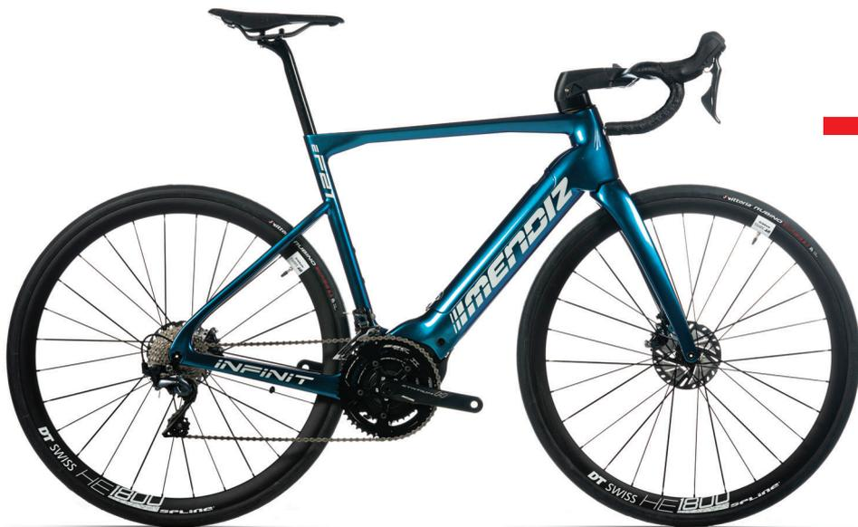
Le moteur Polini du vélo EF21 offre une assistance puissante, similaire aux VTT, avec 250 W de puissance nominale, des pointes à 500 W et un couple maximal de 75 N/m. Alimenté par une batterie de 500 Wh, il propose cinq niveaux d'assistance, ajustables selon le terrain et les besoins.
