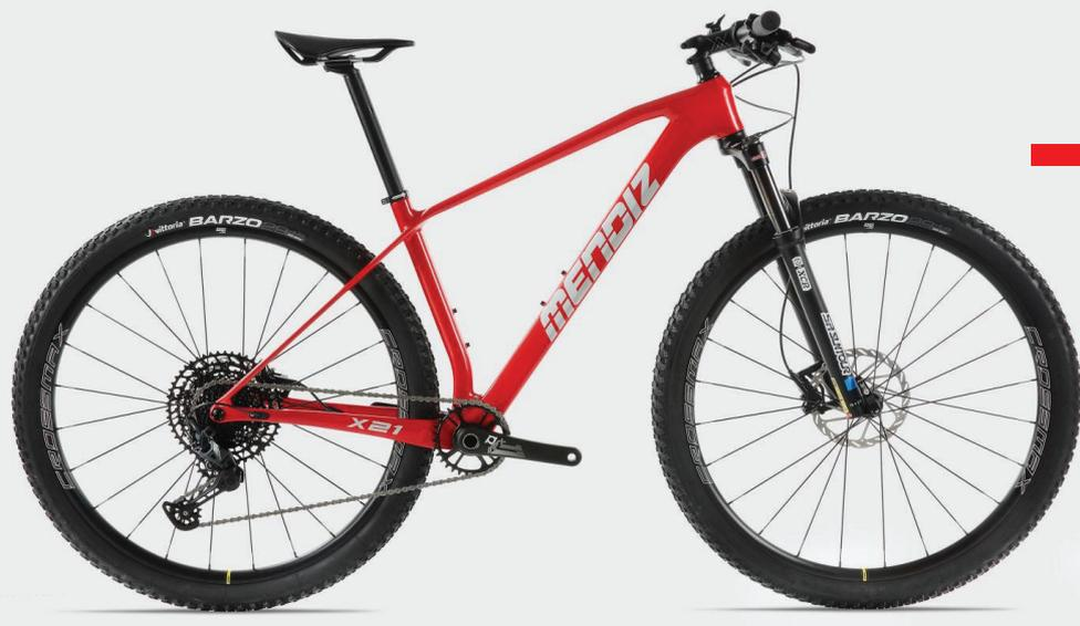
Ce modèle est idéal pour le cross-country en raison de son efficacité et de sa polyvalence. Sa géométrie facilite des montées rapides et des descentes stables. Equipé d'un cadre en carbone, des bases compactes et de la stabilité réussie en inclinant le tube de la selle à 73,5°, permettant concentrer le poids sur le guidon. Avec l'angle de braquage prononcé, les descentes sont un point fort de notre hardtail.
