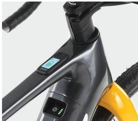
L'écran Polini, intuitif et doté de Bluetooth, permet de contrôler facilement le vélo via un téléphone portable. Avec 5 niveaux d'assistance, le cycliste peut ajuster la puissance selon le terrain, ou désactiver l'assistance pour un pédalage pur.
